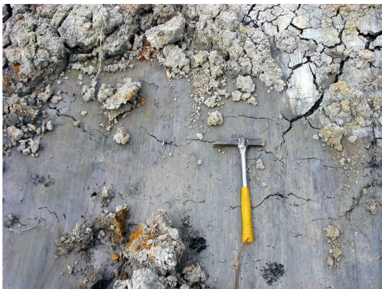
Fig. 4. Powierzchnia poślizgu równoległa do krawędzi skarpy (po niej zsuwają się skały (iły) do dół); jest one nachylone ku SW około 30-45 stopni i charakterystyczne dla górnej części osuwisk.
